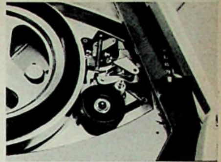
Bild 9. Der dicke Gußteller des Harting-Plattenspielers bewirkt guten Gleichlauf
