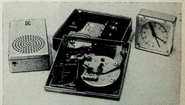
Transistor-Kleinempfänger mit Kurz-, Mittel- und Langwellen (links), ansetzbarer Batterie-Plattenspieler für 45er-Platten (mitte) und Schaltuhr, so daß man sich morgens mit Schallplattenmusik wecken lassen kann (Max Braun)
