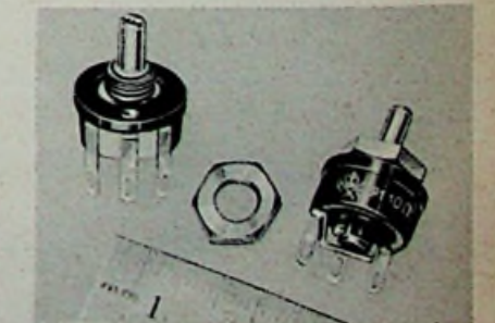
Bild 5 b. Rosenthal-Drahtpotentiometer P 1 in natürlicher Größe
